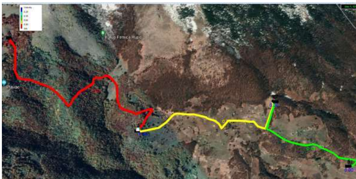
Trase distributivnih cjevovoda krak 1, krak 2 i krak 3.
